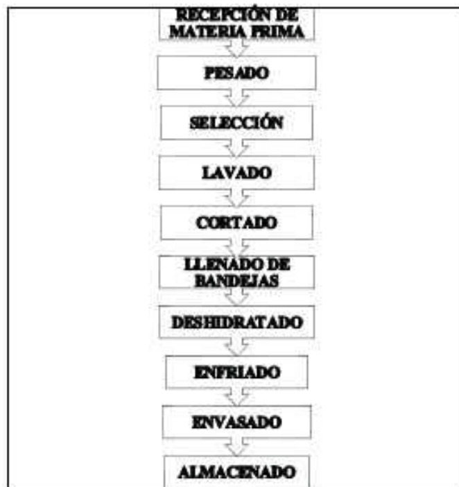
Figura 1. Diagrama de operaciones de elaboración de fruta deshidratada (fresa y manzana)
